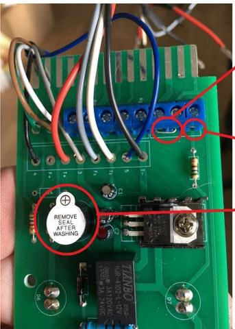
En supprimant le pont vous pouvez couper l'option buzzer « oubli de phare ». Ou vous pouvez le remplacer par un interrupteur pour l'activer ou le désactiver à distance.
