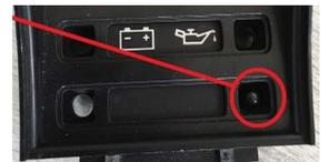
Si il est toujours présent, prenez soin de retirer l'autocollant situé sur le buzzer. Avec il fonctionnera quand même mais sera moins puissant.
