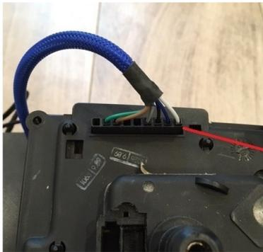
Position du bornier de buzzer d'huile au dos du compteur de vitesse.
